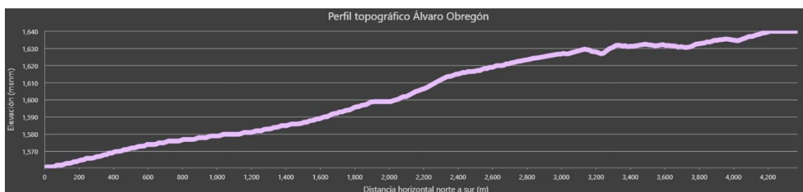
Gráfico 4.- Perfil topográfico de la calle Obregón de norte a sur, se observa una pendiente ascendente en sus cuatro kilómetros.
